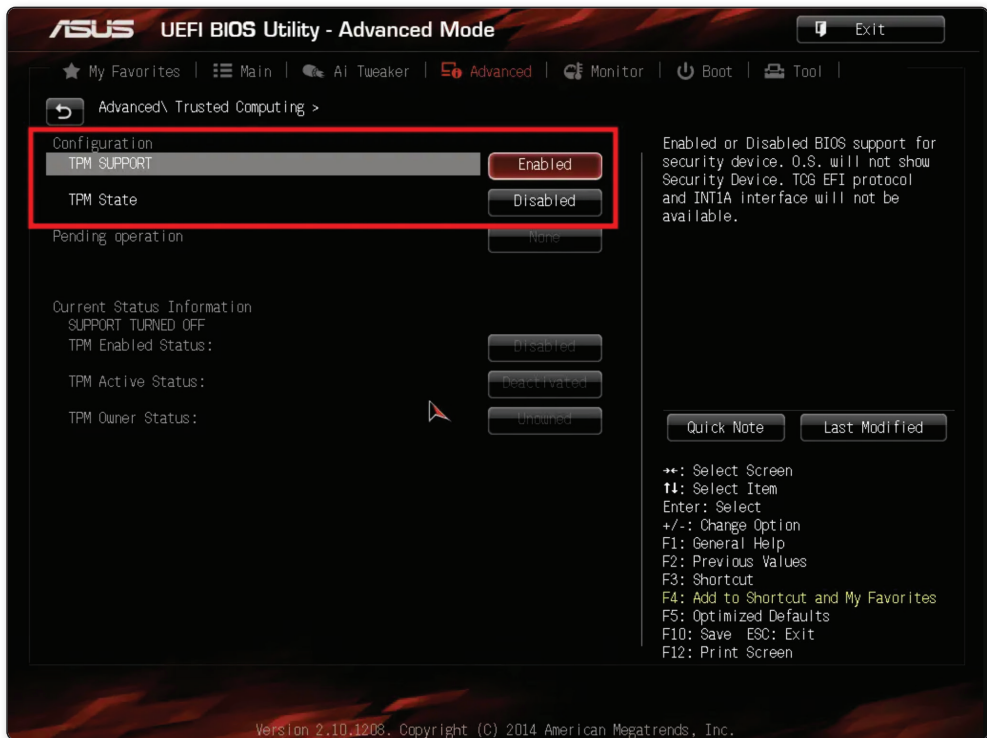
Figura 1.3. Cuando encuentres la opción de configuración del TPM, asegúrate de habilitarla. Guarda los cambios y reinicia el equipo.
